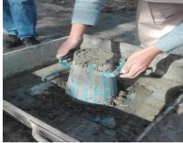
(3.1.1) Slump Test test
